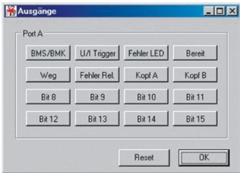
手动切换数字输出以控制测量放大器。
