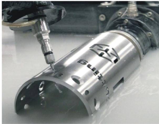
当旋转轴配置 A-Jet 切割头，可以沿着管道的圆周上进行切割，切出鱼形叉口、马鞍切块、沉孔等。
